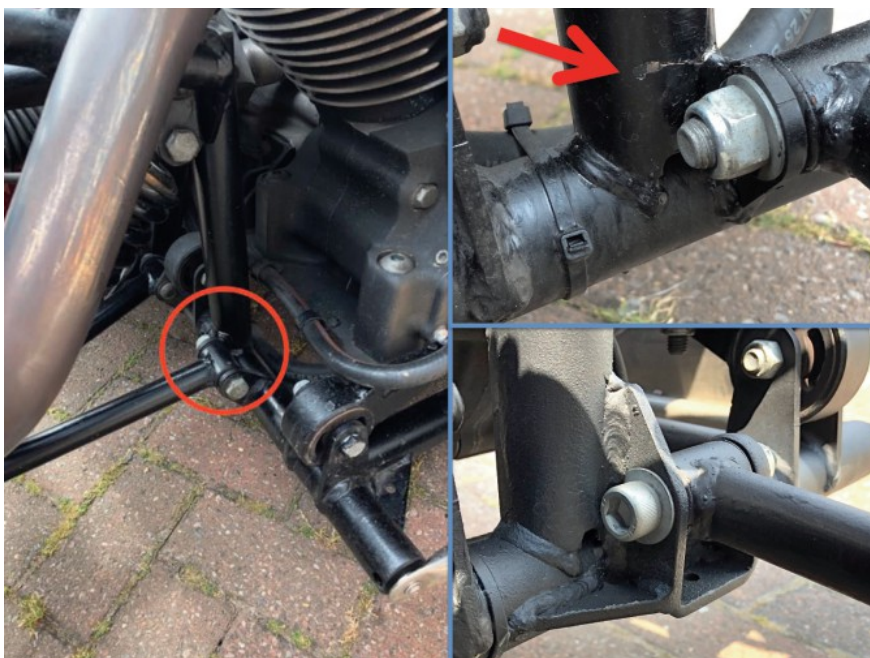
Figure 4 Fissure émanant des pattes de triangle. Support de remplacement illustré en bas à droite.
