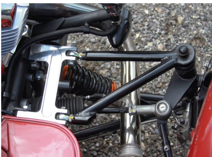
Figure 9 Kit Empire triangle supérieur réglable avec un amortisseur ATR. (Photo de Simon Goldsworthy)
