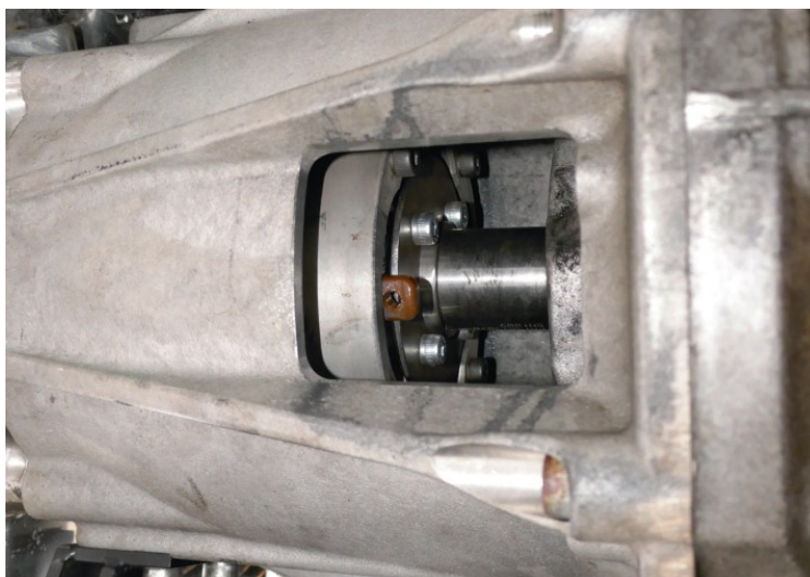
Figure 5 : Dessous du boîtier Centa modifié par Bleazey avec une ouverture oblongue agrandie.
